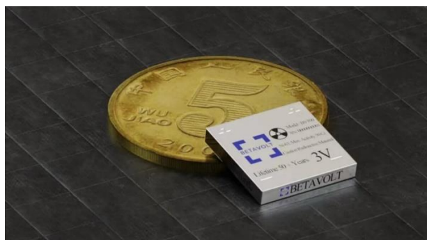
Рисунок 1- Ядерная аккумуляторная батарея для мобильных устройств
